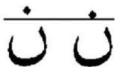
شکل (۲): نمونه نهان نگاری با استفاده از تغییر نقطه برای متن
